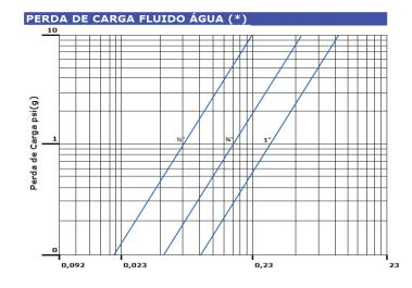
EXEMPLO: Para dete rminar a perda de carga ( $\Delta P$ ) através de um filtro de  $\mathcal{O}1''$  com vazão de 0,23 $m^3$  /h, entre com o valor em  $m^3$  /h na coluna de vazão e desloque verticalmete até encontrar a curva correspondente a bitola desejada, no caso  $\mathcal{O}1''$  e desça horizontalmente até encontrar o valor  $\Delta P$  correspondente que no caso é 0,03 PSI.
