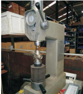
*Teste de dureza do corpo do purgador, importante etapa do processo de recebimento da matéria prima.*
